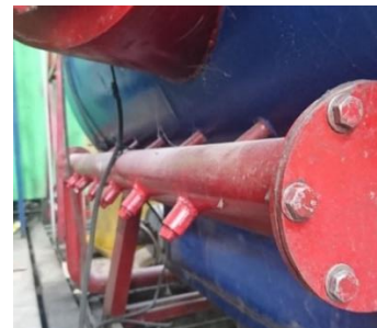
Gambar 3. 6 Kontruksi Pipa Aliran Udara Setelah Modifikasi
